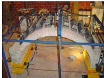
**Figura 9.** Prueba estática de una franja de bóveda de mampostería de ladrillo
