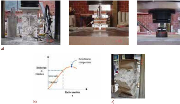
**Figura 5.** Ensayo de materiales para la caracterización de sus propiedades: a) ensayos de resistencia a compresión y módulo de elasticidad; b) curva esfuerzo-deformación; c) ensayo de un murete en compresión diagonal
