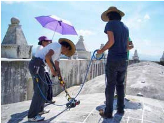
**Figura 3.** Ejemplo de prueba no destructiva mediante el uso de radar
