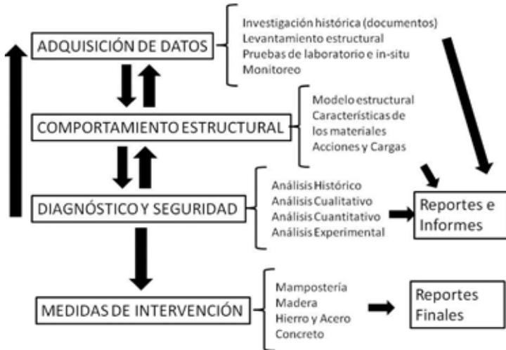
**Figura 1.** Diagrama de flujo con la metodología propuesta por ICOMOS para las intervenciones estructurales de edificios históricos
