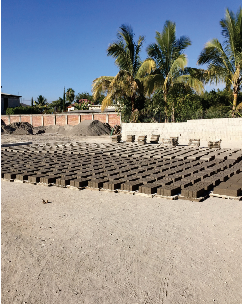
FIGURA 10. SECADO DE LOS BLOQUES DE CONCRETO
