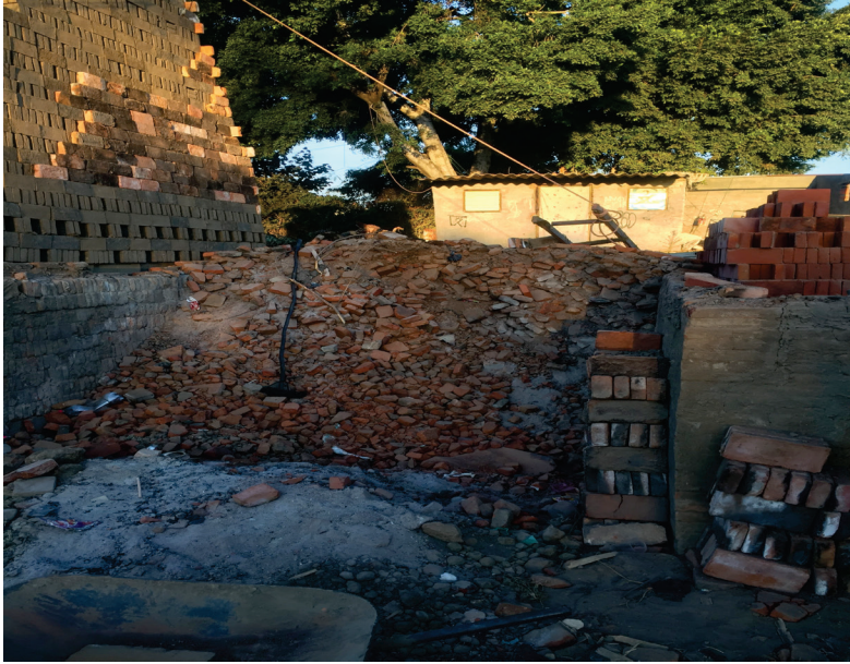
FIGURA 21. ALMACENAMIENTO DE LADRILLOS DEFECTUOSOS HORNEADOS
