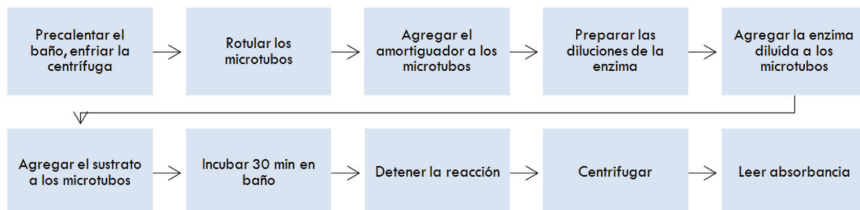
Figura 2. Diagrama de flujo del método cuantitativo para determinar la actividad lipolítica.
