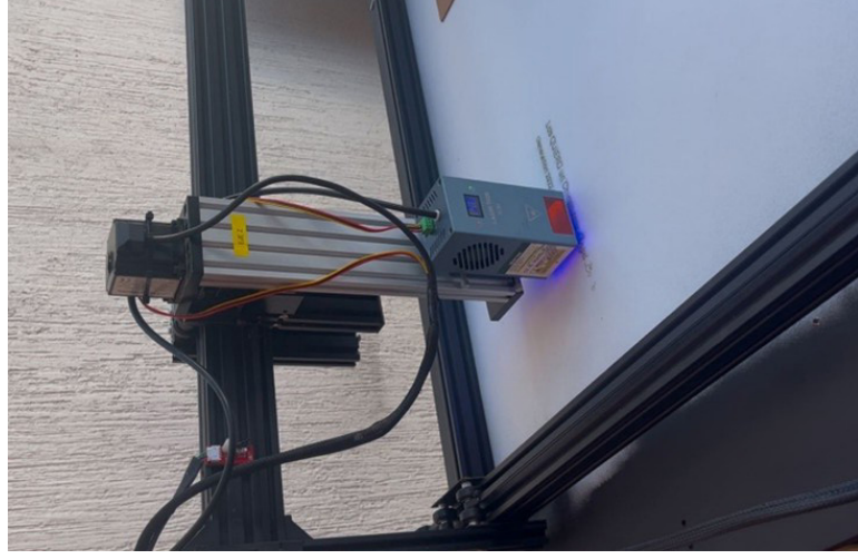
Figura 10. Prueba exitosa del grabado sobre una placa de madera
