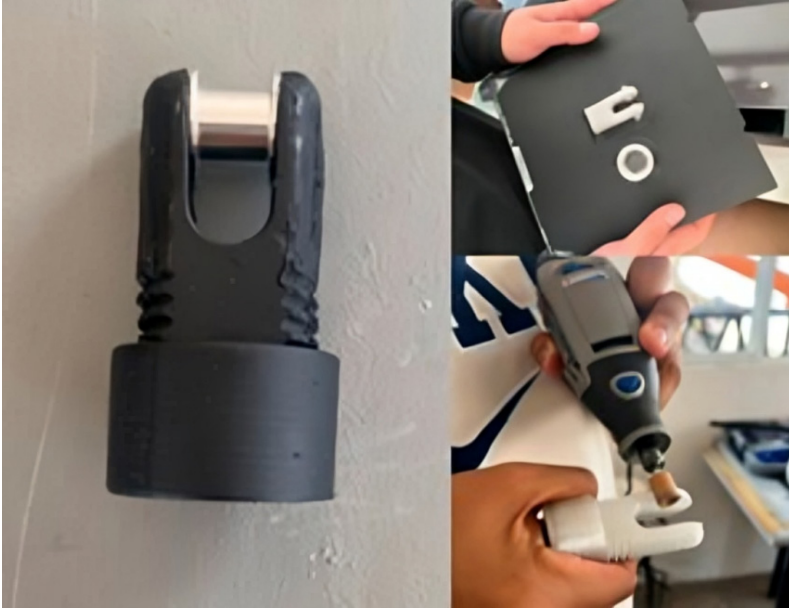
Figura 7. Postprocesado de la impresión del tensor de banda
